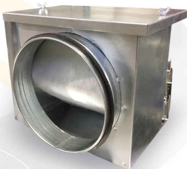
Кассетные фильтры круглого сечения предназначены для «грубой» очистки перемещаемого воздуха от твердых частиц. Корпус изготовлен из оцинкованной стали. Применяется фильтрующий материал из синтетического волокна класса очистки EU3, закрепленный на прямоугольной рамке и выполнен в виде пластины. Съемная крышка фильтра позволяет легко заменять использованную фильтрующую вставку. Фильтры данного типа могут монтироваться в любом положении, рабочий диапазон температур -40 +70 °С.
